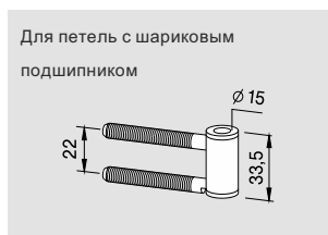
Ось для деревянных рам , оцинкованная сталь, для петель с шариковым подшипником. Макс. вес двери 60 кг. Арт. No. 11.236 Вес в кг: 0.050
